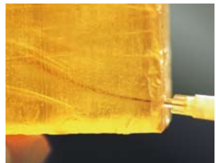
Das berühmte Bild zeigt am Dummy die auch in natura bei Verwendung von konventionellen Kanülen auftretende „Deflektion“.
